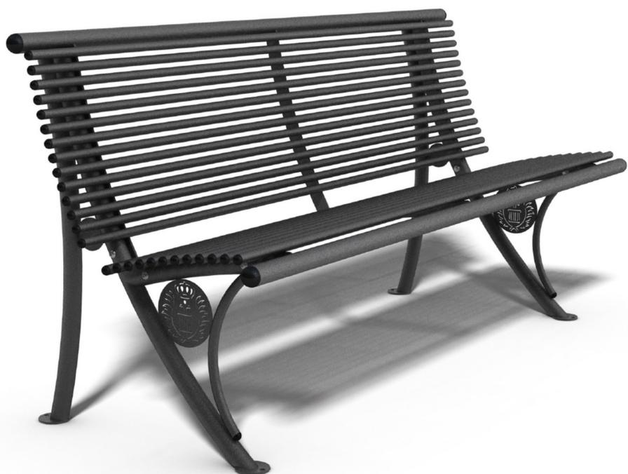
**PANCHINA AMALFI** struttura composta da n.2 supporti di forma arcuata in acciaio zincato e verniciato diam. mm. 40 con piastre per il fissaggio a terra, spalliera e sedile composti da n.26 doghe in tubo tondo di acciaio zincato e verniciato diam. mm. 20 e da n.2 doghe diam. mm. 40 alle estremità.
