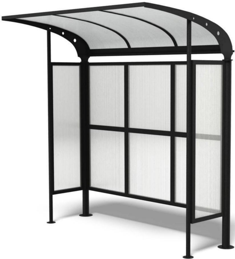
**PENSILINA STOP-BUS** struttura in acciaio zincato e verniciato colore canna di fucile composta da n° 02 montanti posteriori in tubo tondo diam. mm. 76x2 e n° 02 montanti anteriori in tubo tondo diam. mm. 40x1,5 completi di piastre circolari per il fissaggio a suolo.
