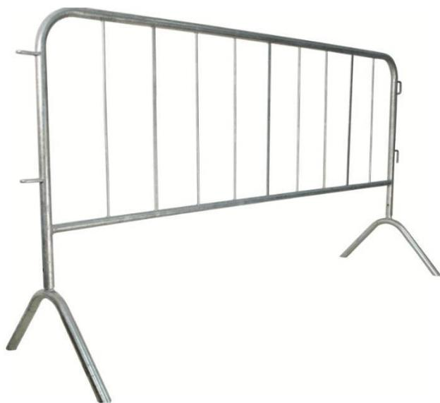
Transenna modulare realizzata in acciaio zincato a caldo con piedi intercambiabili e sfilabili salvaspazio, struttura perimetrale con tubo di acciaio diam. mm. 32 con tondini verticali saldati alla distanza di cm. 12. Completa di n. 2 ganci e n. 2 graffe per aggancio transenne.
